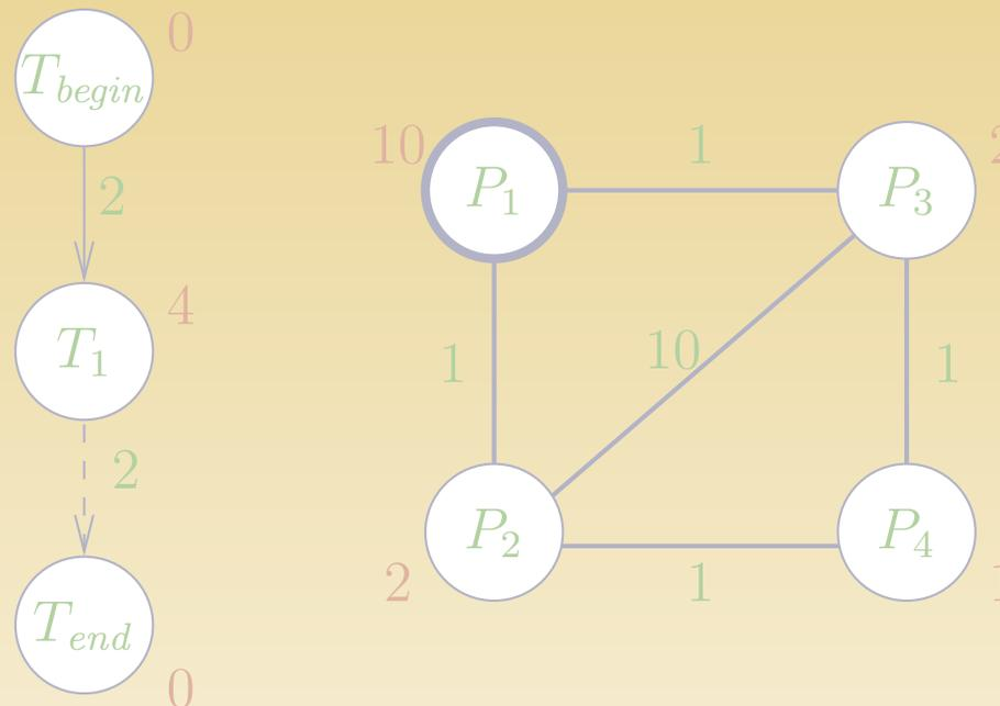
Chaque arête  $e_{k,l} : T_k \rightarrow T_l$  de  $G_A$  est étiquetée par un coût de communication  $data_{k,l}$  représentant la quantité de données créées par  $T_k$  et utilisées par  $T_l$ .
