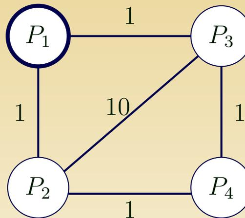
Chaque arête  $P_i \rightarrow P_j$  est étiquetée par  $c_{i,j}$  : le temps nécessaire à l'envoi d'un message de taille unitaire entre  $P_i$  et  $P_j$ .
